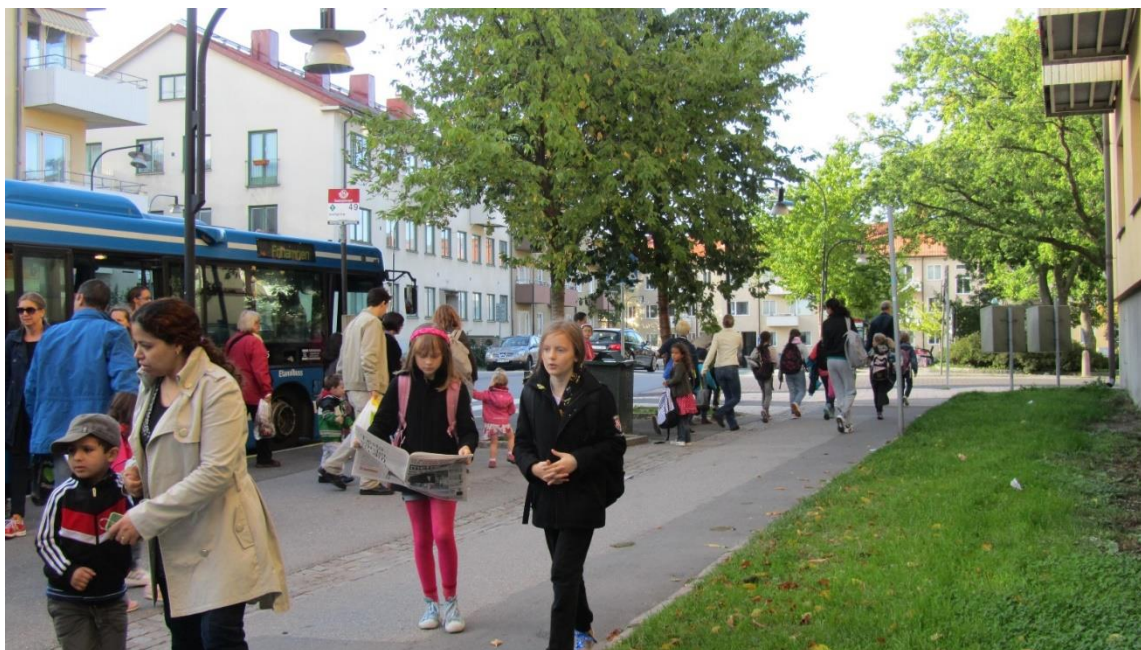
Figur 3-5 Gångbanebredd mellan gräs och kantsten cirka 6,5 meter, obs! endast avstigningshållplats. Mått mellan träd och gräsmatta cirka 3,7 meter. Foto: WSP
