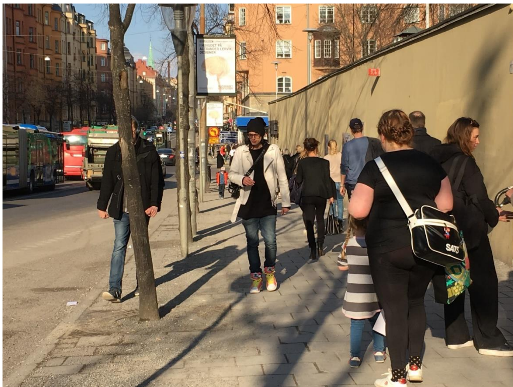
Figur 3-1 Gångbaneläbredd cirka 4,5 meter mellan kantstöd och vägg. Foto: WPS
