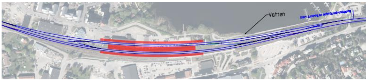
Figur 27. Alternativ A uppritat av spårprojektör och applicerat på ortofoto.
