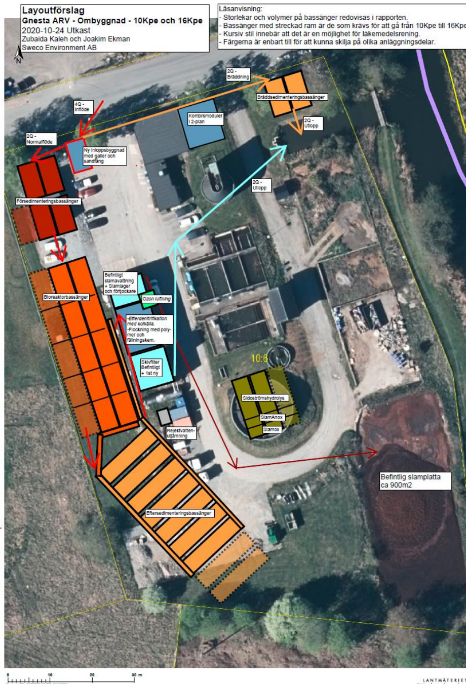
Figur 2: Layoutförslag för ombyggda Gnesta avloppsreningsverk.
