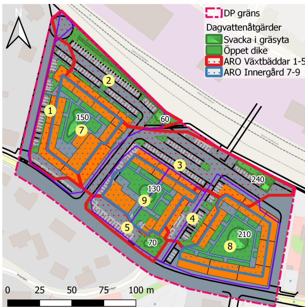
Figur 9. Illustration av avrinningsområden (markeras med gul ring) till olika LOD-anläggningar. De olika svackorna motsvarar ytan för att kunna omhänderta dimensionerande regn för dess avrinningsområde. Bakgrundskarta: OpenStreetMap.
